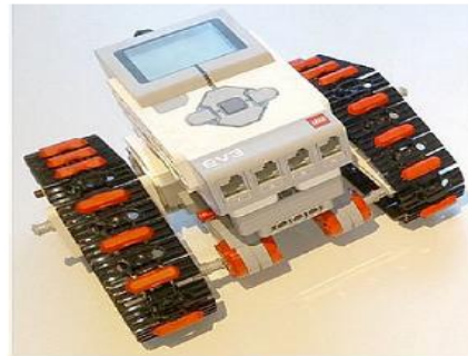
Structure de Rover Lego EV3
